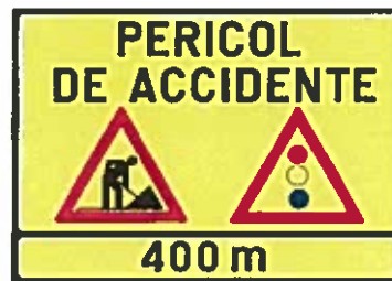
a44 - Presemnalizarea unui sector cu circulație alternantă
