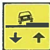
a28 - Adițional - Denivelare față de banda alăturată
