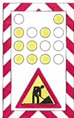
a41 - Semnalizarea unui utilaj care se deplasează lucrând
